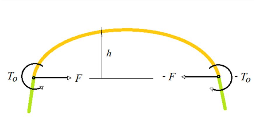
Este es sostenido en reposo por medio de la aplicación en puntos similares de sus extremos, de una fuerza  $F$  y un torque  $T_0$ . Despreciando el peso del espagueti, y considerando que su ruptura se produce cuando el torque en cierta sección llega a ser un valor máximo  $T_{max}$ , responda entonces las siguientes preguntas:
